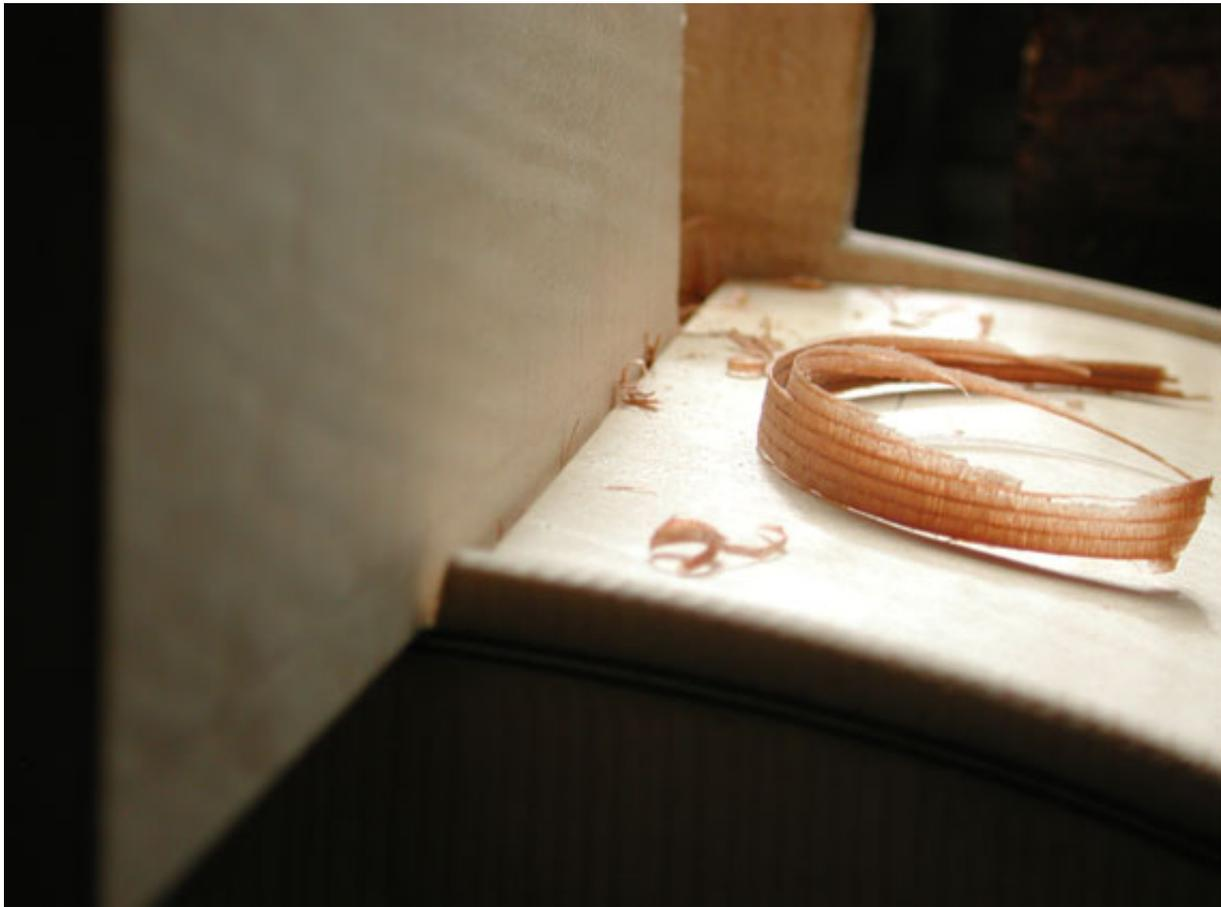
Der Halsfuß wird langsam in den Ausschnitt eingepasst
