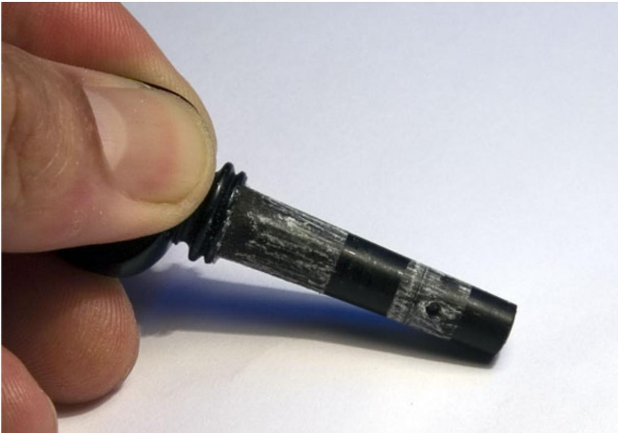
Genau sieht man, dass der Wirbelkasten sich überall an der Lauffläche abzeichnet. Damit ist feines Stimmen nach Abschluß dieser Arbeiten gewährleistet.
