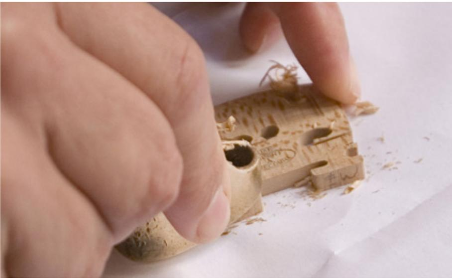
Als nächstes werden die StegfüÙe an die Deckenwölbung angepasst. Dies erfordert äußerste Präzision, denn die Passgenauigkeit entscheidet über eine optimale Schwingungsübertragung.
