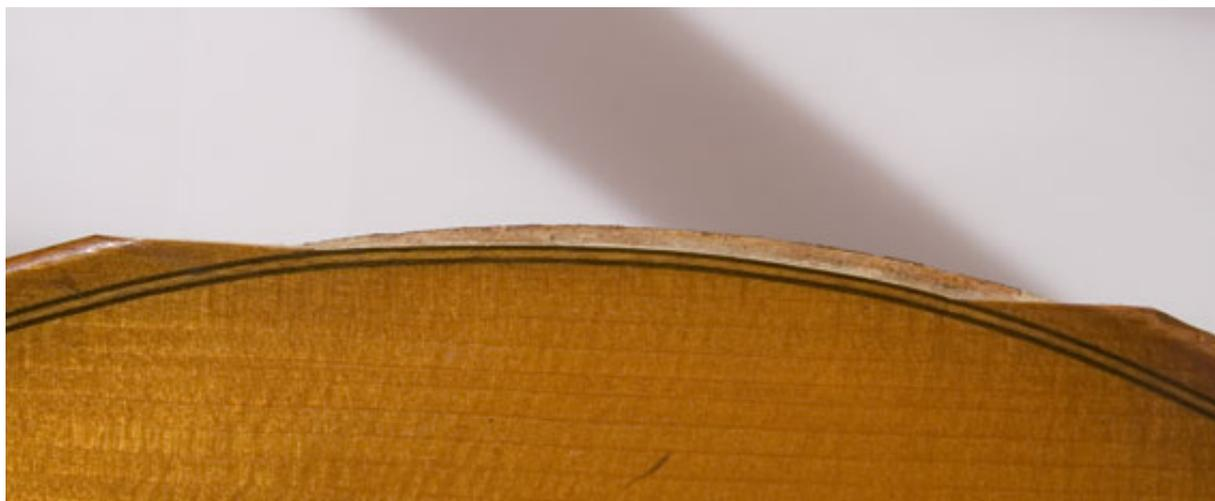
Auf diesem Foto ist der fertig vorbereitete Rand zu erkennen. Entscheidend ist hierbei, dass alle Flächen exakt gerade abgerichtet sind. Dies wird mit einem Präzisionshaarlineal überprüft.
