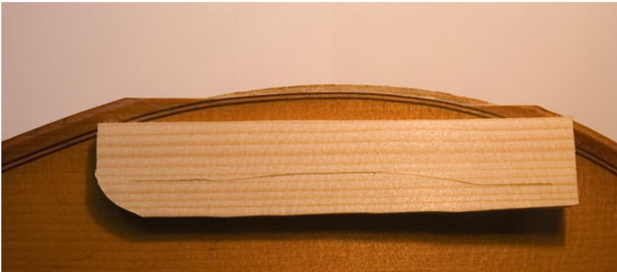
Das ausgesuchte Holz soll von der Struktur, seiner Spaltrichtung, seiner Jahresringbreite und seinem Spiegel möglichst gut zum Original passen. Der Geigenbauer hat in der Regel einen großen "Schatz" alter abgelagerter Hölzer, so dass für jedes alte Instrument passendes Holz vorhanden ist. Da unserer Werkstatt seit 1932 besteht, können Sie sich sicher vorstellen, dass wir einen großen Vorrat an Reparaturholz in allen Variationen haben.
