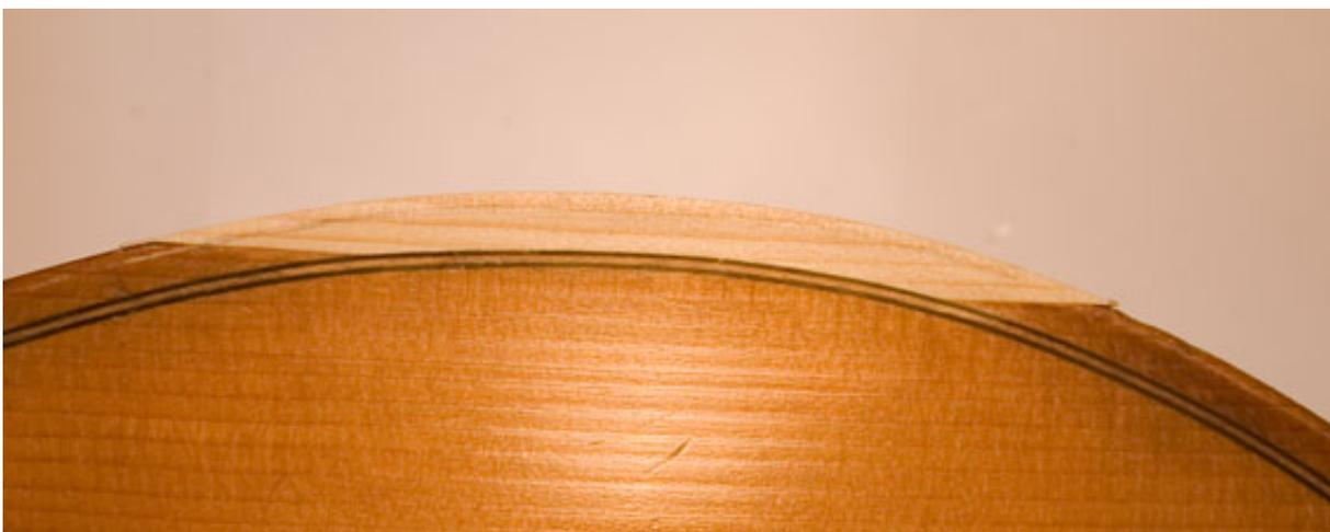
Das Holz wird nun dem Umriss entsprechend abgeschnitten, gehobelt und gefeilt. Die Hohlkehle wird
