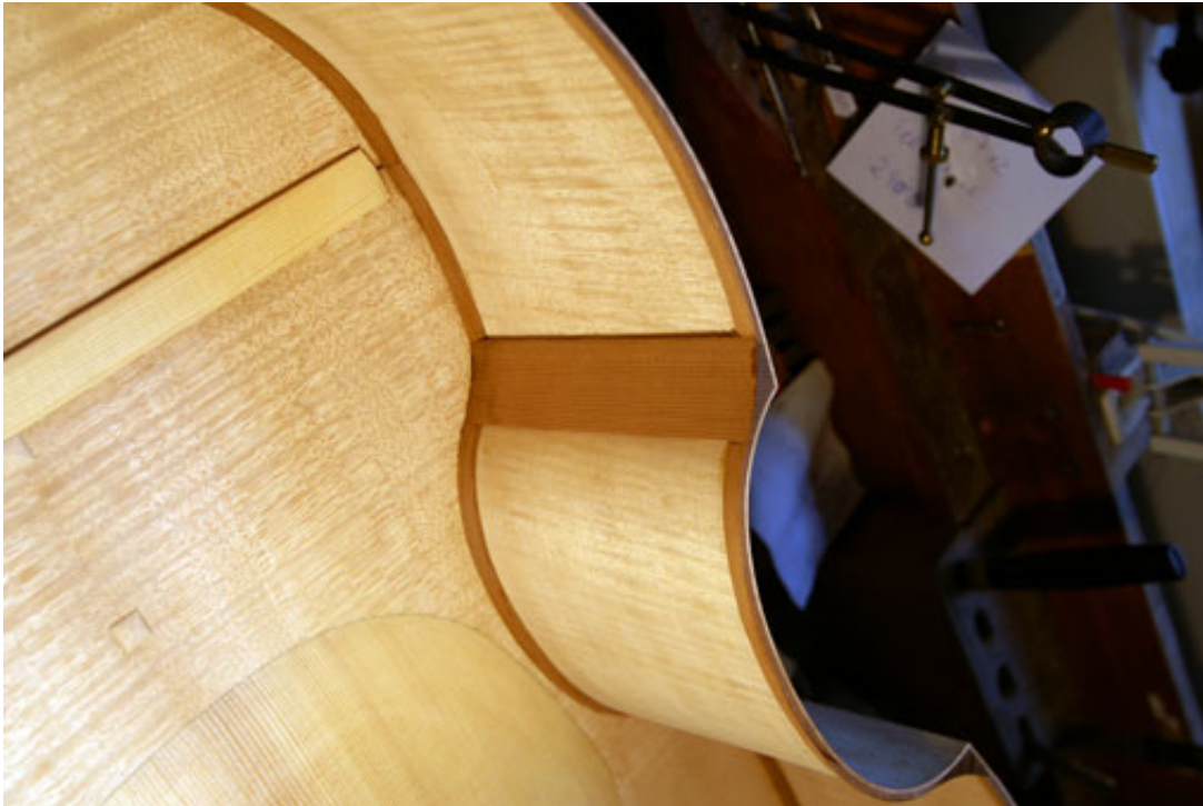
Gehrungszusammenschluss der Gambenzargen
